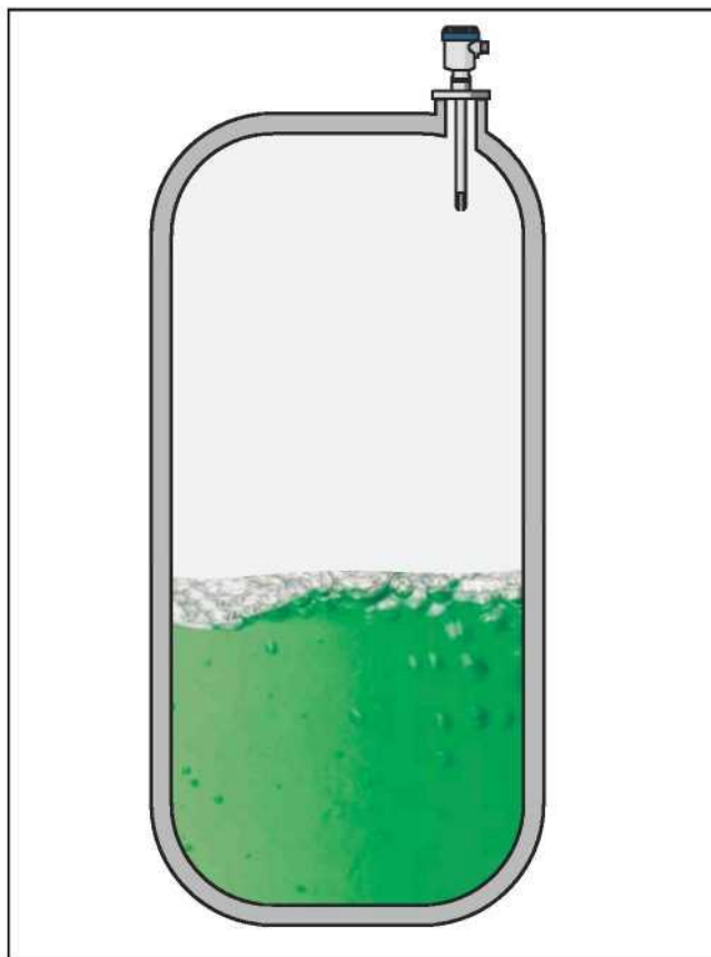
Рис. 1: Сигнализация уровня в сосуде с растворителем.
